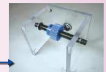
在框架上安装齿轮轴。
