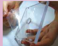
揭去所有框架板的保护膜。
